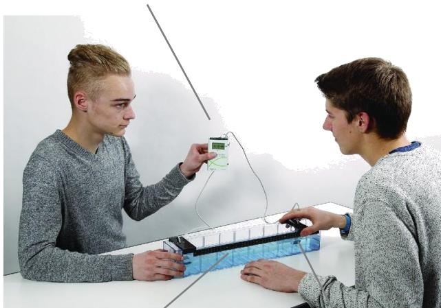
**Cuve graduée** : permet d'ajuster facilement la distance émetteur-récepteur
