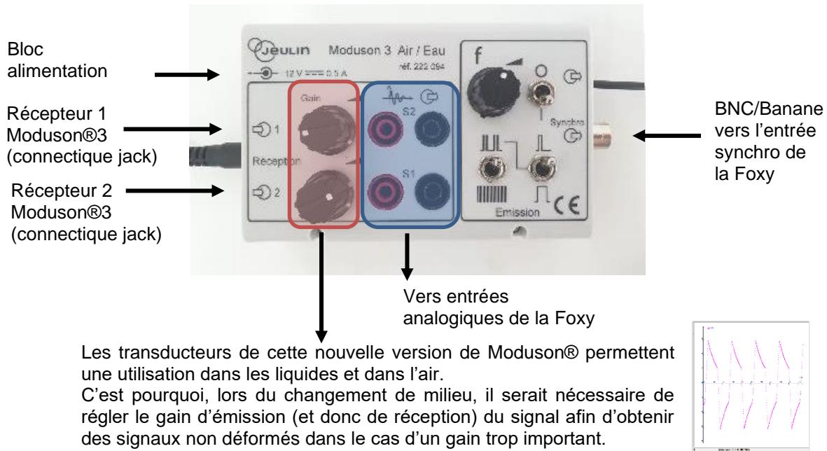
Exemple de montage – Mesure de la vitesse du son dans l'eau :
