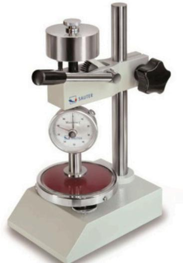
Le banc d'essai TI pour les duromètres Shore peut être acheté en option en plus du duromètre HB.
