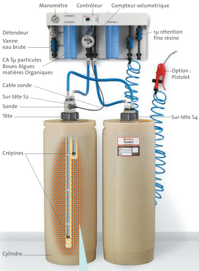
Dans un lit mélangé; les H<sup>+</sup> et OH<sup>-</sup> préalablement fixés sur les matrices des résines cationique et anionique lors des phases de régénération, s'échangent avec les cations (+) et anions (-) présents dans l'eau. Les résines sont ensuite presque entièrement saturées et doivent être régénérées. Ces ions H<sup>+</sup> et OH<sup>-</sup> libérés se recombinent instantanément pour créer de nouvelles molécules d'eau : H<sup>+</sup> + OH<sup>-</sup> → HOH → H<sub>2</sub>O
