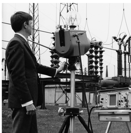
Figure 14.2 1969 : Thermovision, modèle 661. La caméra pesait environ 25 kg, l'oscilloscope 20 kg et le trépied 15 kg. L'opérateur avait également besoin d'un groupe électrogène de 220 VCA et d'un récipient contenant 10 l d'azote liquide. À gauche de l'oscilloscope, on distingue le Polaroid (6 kg).
