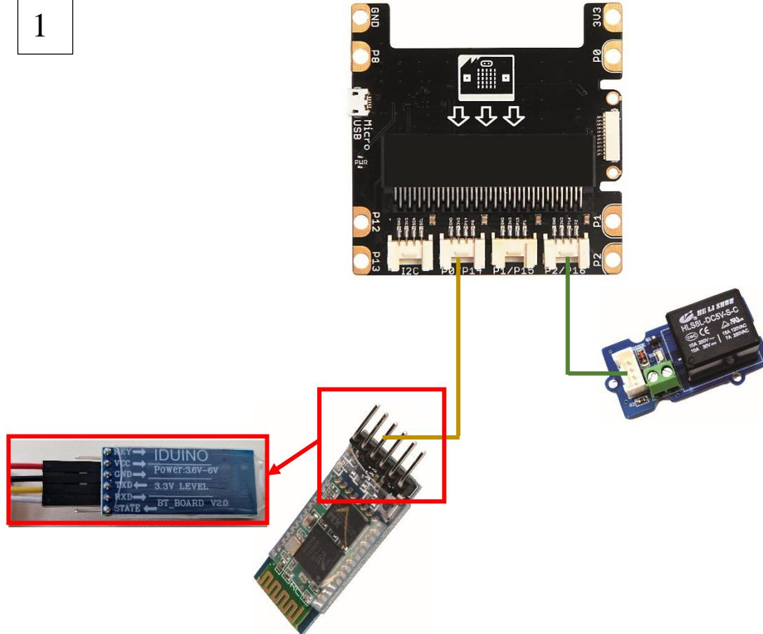
3- Connecter maintenant les capteurs/actionneurs en suivant les instructions suivantes :
