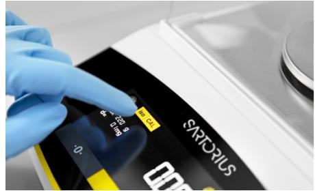
**isoCAL (étalonnage et ajustage internes) pour la garantie totale de résultats de pesée précis**
