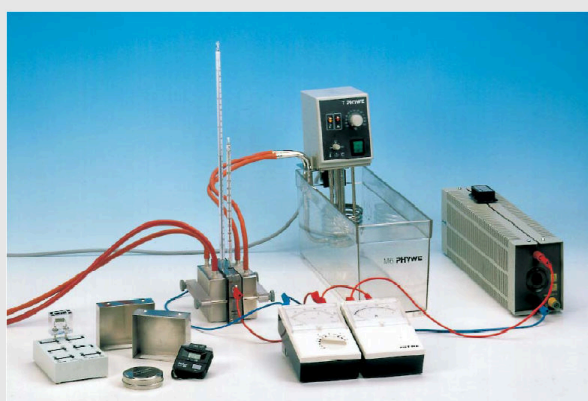
Fig. 1 : Montage expérimental pour la mesure de la tension à vide et du courant de court-circuit en fonction de la différence de température.
