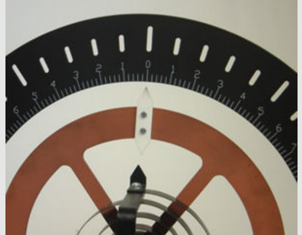
Fig. 4 : Pointeur du pendule à la position zéro.
