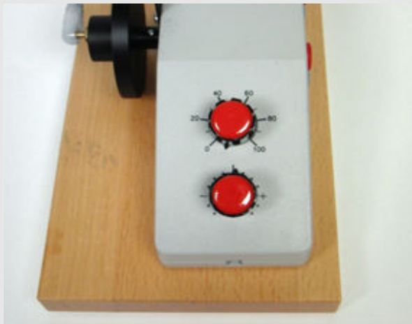
Fig. 5 : Boutons de commande pour régler le potentiomètre du moteur. Bouton supérieur : "grossier" ; bouton inférieur : "fin".
