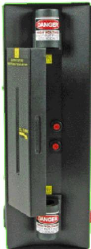
L'alimentation pour tubes est un appareil sous HAUTE TENSION qui peut délivrer jusqu'à 5 000 Volts.
