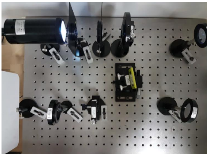
Le faisceau lumineux polychromatique issu de la source traverse la fente d'entrée (F1). Celle-ci est dans le plan focal du miroir concave de collimation (M1). Tous les rayons réfléchis par le miroir sont donc parallèles lorsqu'ils arrivent sur le réseau.
