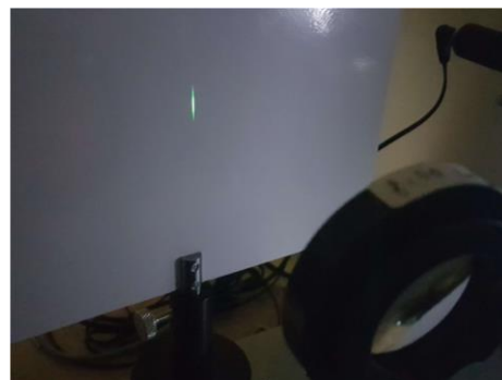
Raie sélectionnée et focalisée sur l'écran d'observation.
