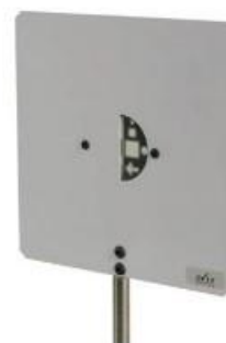
Ecran d'auto-collimation avec l'objet éclairé (AB).
