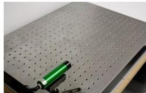
2. Fixer la hauteur à 9 cm sur toute la longueur de la table par « défilement » (mesures successives de la hauteur du laser en étant proche de la sortie du module puis éloigné etc...).
