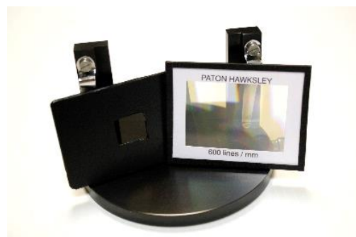
Sur-platine porte-réseaux présentée avec le réseau de diffraction et la lame de quartz en monture.
