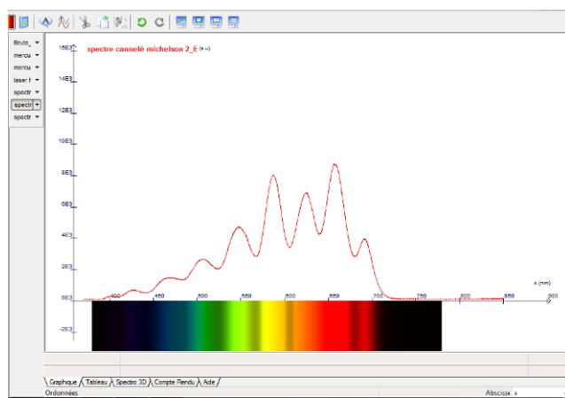
En « chariotant » dans le bon sens, les cannelures deviennent de plus en plus espacées. Elles deviendront « visibles » lorsque le spectre cannelé deviendra presque plat oscillant tantôt entre rouge et le bleu vert...
