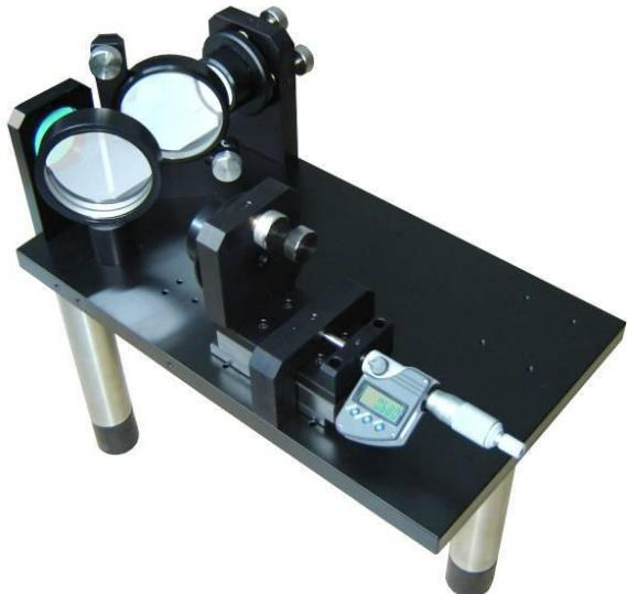
L'interféromètre est un modèle OVIO 202607, il est éclairé par une lanterne 201051 12V-75W. Dans cette expérience, on s'est rapproché du contact optique avec une source mercure 202565. On se propose d'aller vers la teinte plate, directement avec une lampe blanche, en observant les cannelures du spectre en en plaçant l'extrémité fibre optique de SpectroVio II dans le champ d'interférences.
