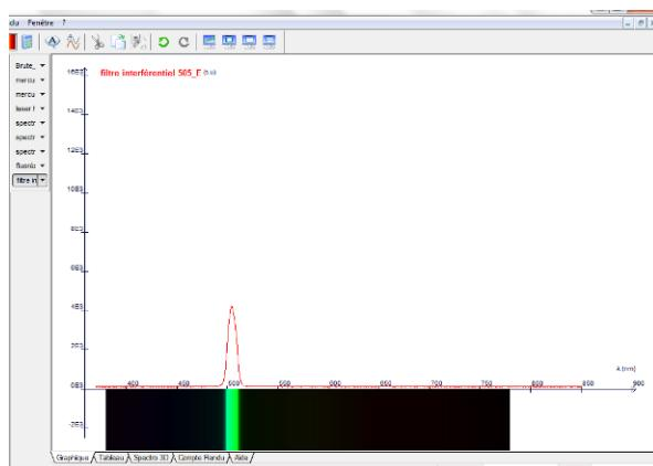
Un filtre interférentiel est habituellement utilisé pour sélectionner une longueur d'onde, c'est un filtre très sélectif avec une bande passante d'une dizaine de nanomètres.
