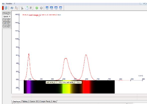
Une led est un composant électronique capable d'émettre de la lumière lorsqu'il est parcouru par un courant électrique. Son rayonnement est spectralement bien marqué, même si il reste loin d'être monochromatique (la bande d'émission est de l'ordre de 50 à 100 nm).
