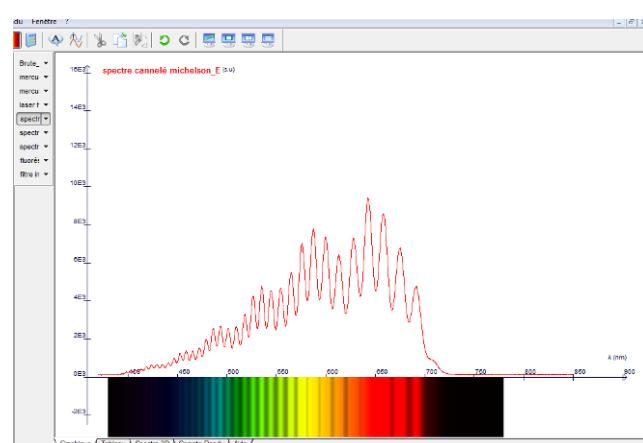
Ci-dessus, les cannelures apparaissent, encore très serrées tant le contact optique est encore éloigné.
