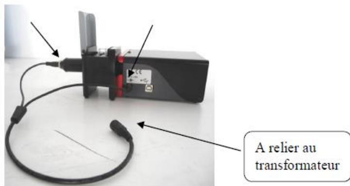
Fixer le porte cuve par emboîtement magnétique sur le spectromètre. Lors du changement de la cuvette, il est préférable de maintenir le porte cuve.
