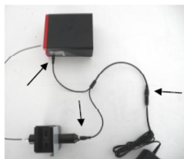
Explication étape par étape du montage de la sortie SMA pour fixation fibre :
