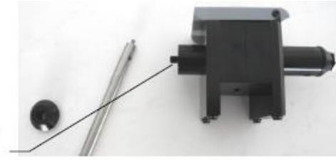
**Etape 4 :** Relier la fibre du spectromètre au porte cuve.
