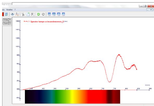
L'ampoule à filament émet un spectre continu du proche ultraviolet (très faible) à l'infrarouge. En fonction de l'ampoule utilisée, on relève une intensité plus ou moins élevée dans les infrarouges (filament standard, tungstène, ampoule à réflecteur métallique, dichroïque...). Le bleu du ciel ou l'émission du soleil peut également être observée.
