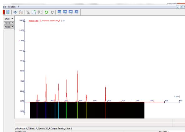
La source au mercure et au cadmium superpose les raies des deux sources.
