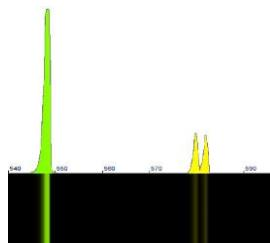
La lampe à mercure 202565 est constituée d'une ampoule en verre remplie de gaz, sous basse pression, au travers duquel on fait passer un courant électrique, il s'en suit une production de photons.
