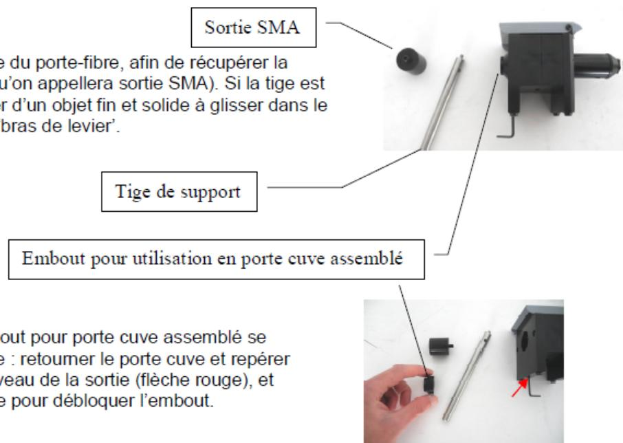
**Etape 2 :** Dévisser l'embout pour porte cuve assemblé se trouvant sur le porte cuve : retourner le porte cuve et repérer la vis qui se trouve au niveau de la sortie (flèche rouge), et utiliser la clé Allen fournie pour débloquer l'embout.
