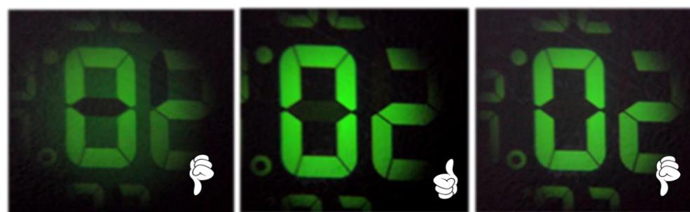
Le contraste idéal de ces digits s'obtient pour un maximum de luminosité ou une extinction du fond de l'écran LCD, ce dernier n'étant soumis à aucune différence de potentiel. Les digits ont toujours une polarisation croisée à celle du fond, ceci permet une lecture aisée de l'affichage.
