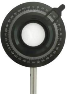
Par ailleurs, on peut remarquer qu'en tournant l'index du polariseur, l'intensité lumineuse varie selon la position de l'index. Une fois que l'index est bien sur le  $0^\circ$ , vérifier que le faisceau du laser est toujours bien centré sur le luxmètre.
