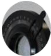
*Cet écran LCD étant naturellement polarisé à 90°, fixer l'index du polariseur à 45° et faire varier l'angle de l'analyseur.*
