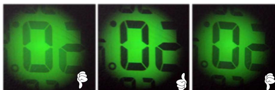
Il est possible d'inverser l'affichage pour obtenir un contraste négatif : fond sombre et segments lumineux. Pour cela, placer l'index de l'analyseur sur des positions d'extinction déterminées dans la partie précédente (45° ou 225°).
