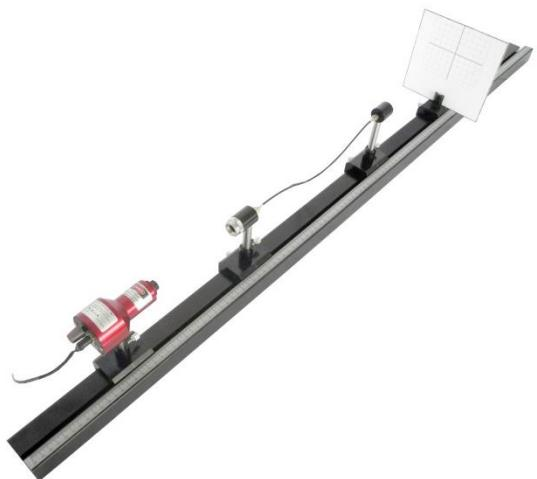
L'ouverture num  rique de la fibre est donn  e par la formule suivante :  $O.N. = \frac{x}{2d}$ , o   x repr  sente le diam  tre de la tâche laser et d, la distance entre l'cran et la sortie de la fibre.
