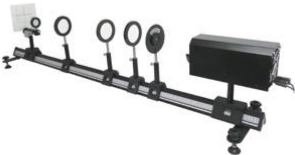
Le grossissement du système est déterminé par le rapport suivant :  $G = \frac{\alpha'}{\alpha}$ . On désigne par  $\alpha'$ , l'angle sous lequel est vu l'image formée par le système et  $\alpha$ , l'angle sous lequel est vu l'objet. En utilisant l'approximation des petits angles, l'expression du grossissement pour un tel système est :  $G = \frac{f'_1}{f'_2}$ .
