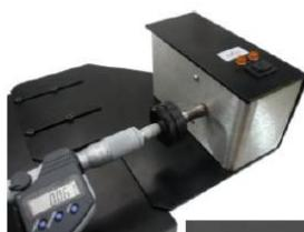
Le fonctionnement de l'interféromètre avec moteur interdit le balayage manuel. Lorsque le moteur est embrayé, le forçage manuel peut endommager tout ou partie de la motorisation.
