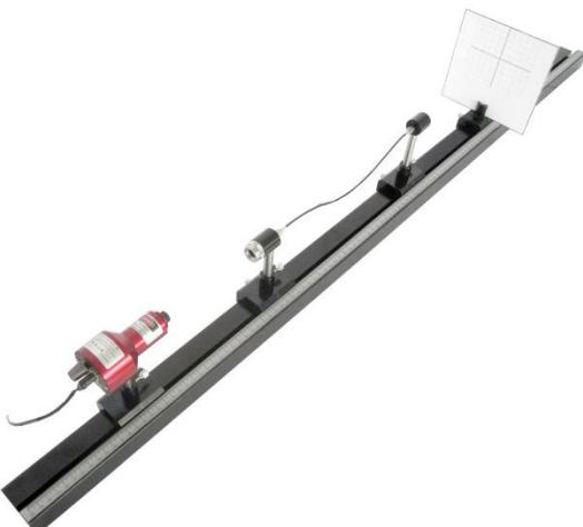
L'ouverture numérique de la fibre est donnée par la formule suivante :  $O.N. = \frac{x}{2d}$ , où x représente le diamètre de la tâche laser et d, la distance entre l'écran et la sortie de la fibre.
