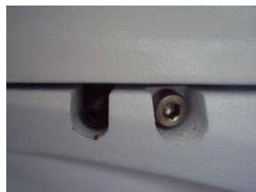
Visser la vis de droite avec la clé 6 pans 3 mm (fournie avec le statif) jusqu'en butée, sans forcer. Cette vis permet de maintenir la tête dans son logement.
