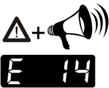
La sécurité de haute température est fermement adaptée à 85°C et travaille sans dépendre du circuit de réglage.
