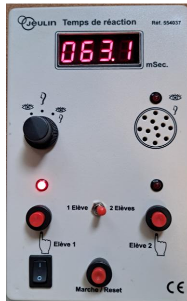
L'élève appuie sur Elève 1 pour stopper le chronomètre et définir le temps de réaction
