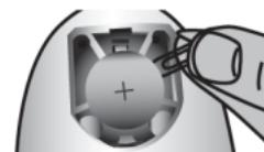
3. Fermez le clapet du compartiment de la batterie. Vérifiez que votre lecteur fonctionne. S'il ne s'allume pas, la pile a peut-être été mal insérée. Retirez la pile et réinsérez-la comme indiqué.
