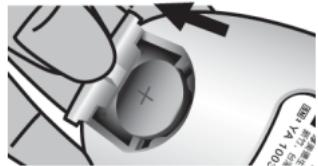
2. Retirez l'ancienne pile et insérez la nouvelle pile au lithium de 3 volts dans le compartiment de la pile en veillant à aligner correctement les signes plus (+) et moins (-).
