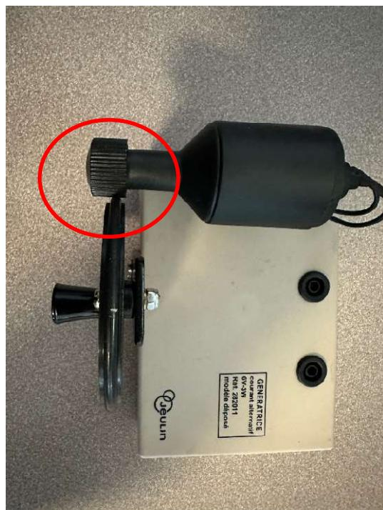
Pour la débrayer, effectuez un mouvement de rotation de la dynamo vers la gauche :
