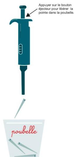
**Remarque :** il est possible de pratiquer le « pipetage inverse » : pour cela, appuyer sur le second cran du piston pour prélever le liquide, puis appuyer jusqu'au premier cran pour rejeter le liquide. Cette méthode permet d'être encore plus précis mais nécessite plus de liquide et à l'inconvénient que du liquide est perdu dans le cône lorsqu'on l'éjecte. On peut éjecter le liquide prélevé en surplus resté dans le cône, mais on risque de contaminer le tube de réactif initial.
