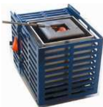
Stérilisation des anses de platine, Elles sont portées au rouge en quelques secondes
