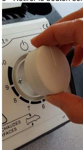
6 - Mettre l'appareil à champ et à l'aide d'un tournevis cruciforme, dévisser entièrement la vis de maintien de la façade avant.
