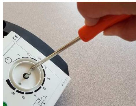
8 - À l'aide d'un tournevis à tête plate, soulever la façade en commençant par un des bords.
