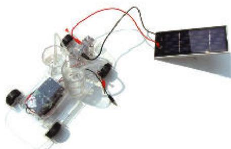
Placez le panneau solaire dans la lumière directe du soleil. Avec une forte lumière du soleil, vous pourrez voir la production d'hydrogène et d'oxygène dans les cylindres intérieurs. Cela prendra approximativement entre 5 à 10 minutes pour remplir le cylindre intérieur d'hydrogène.
