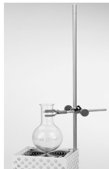
Fixation d'un ballon fond rond au moyen d'une tige pour becs électrique LAB 2 et LAB 3 (réf. 703 087).
