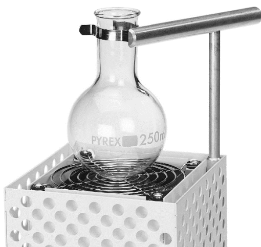
Maintien d'un ballon fond rond à l'aide du support pour verrerie (réf. 703 522)
