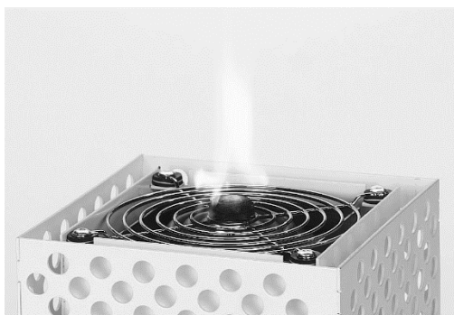
Production d'une flamme sur la grille du bec électrique avec une pastille Ecoflam
