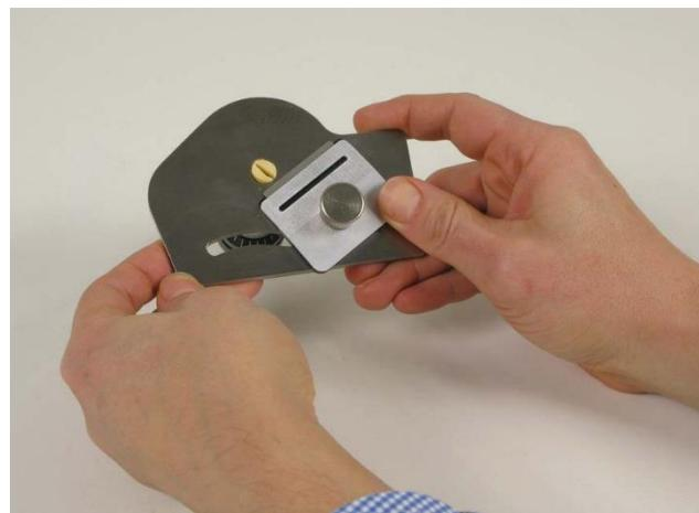
Le premier coup sert à araser la coupe. Après chaque coup, tourner la bague inférieure de 5 à 10 graduations (100 à 2000 µm) jusqu'à ce qu'apparaisse l'objet à trancher.
