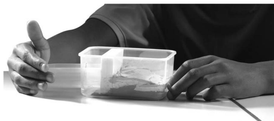
Les couches de matériaux étant en place, maintenir avec une main l'extrémité de la cuvette où se trouvent les couches à compresser.
