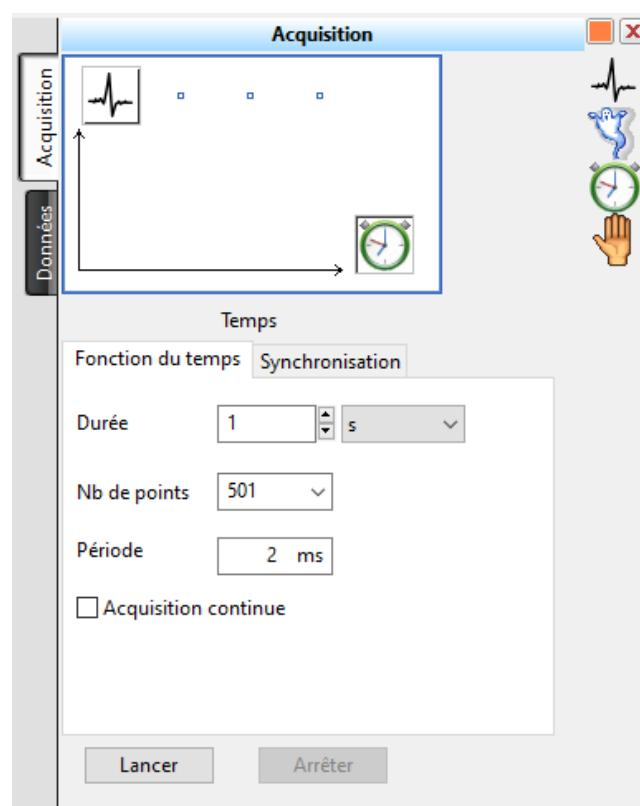
L'utilisateur doit modifier la durée d'acquisition et le nombre de points dans l'onglet « Fonction du temps » comme suit.
