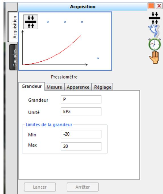
Il reste à paramétriser le temps, en glissant-déposant l'icône du chronomètre en abscisse dans le graphique, comme ci-dessous :
