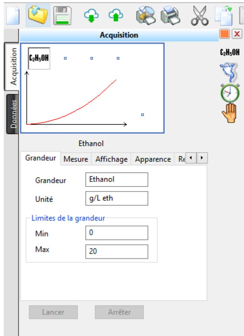
Il reste à paramétriser le temps, en glissant-déposant l'icône du chronomètre en abscisse dans le graphique, comme ci-dessous :
