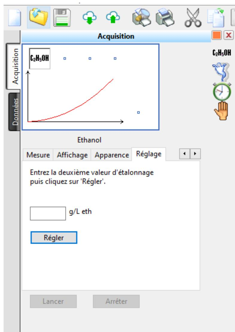
Cliquer dans régler pour valider l'étalonnage
