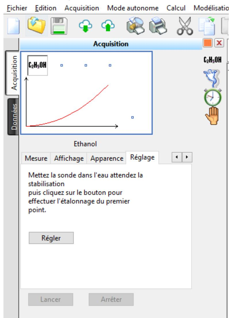
Suivre le protocole indiqué en plaçant la sonde dans l'eau et cliquer pour valider le premier point de mesure de l'étalonnage.
