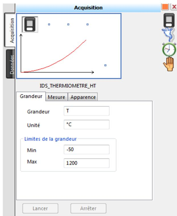
Il reste à paramétrer le temps, en glissant-déposant l'icône du chronomètre en abscisse dans le graphique, comme ci-dessous :
