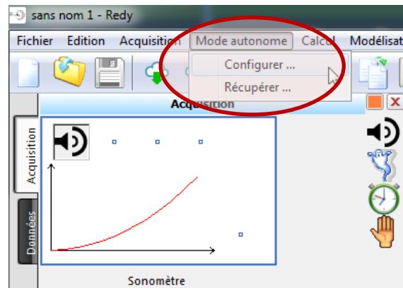
Dans la fenêtre de récupération, sélectionner votre capteur d'intérêt, puis cliquer sur OK.
