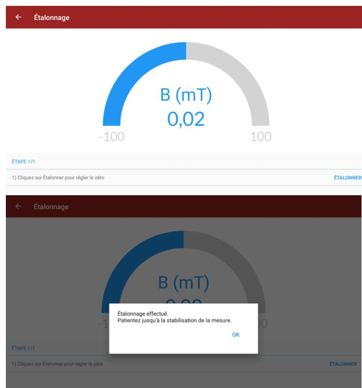
Cliquer sur OK. L'étalonnage de la sonde est terminé.
