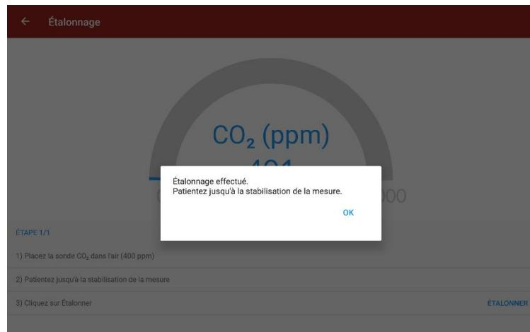
Cliquer sur OK. L'étalonnage de la sonde est terminé.
