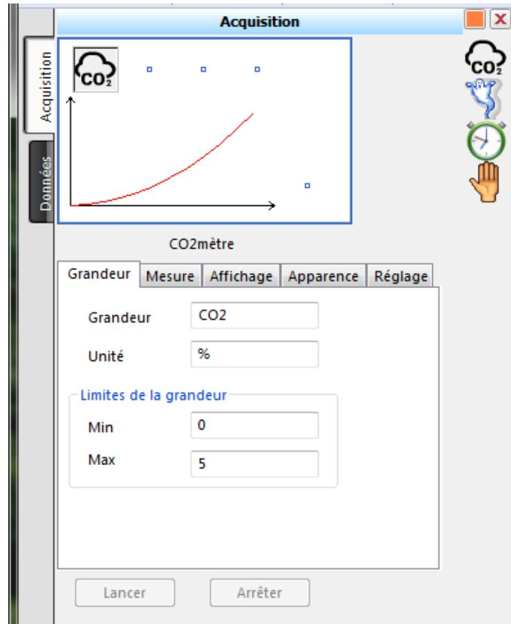
Il reste à paramétriser le temps, en glissant-déposant l'icône du chronomètre en abscisse dans le graphique, comme ci-dessous :
