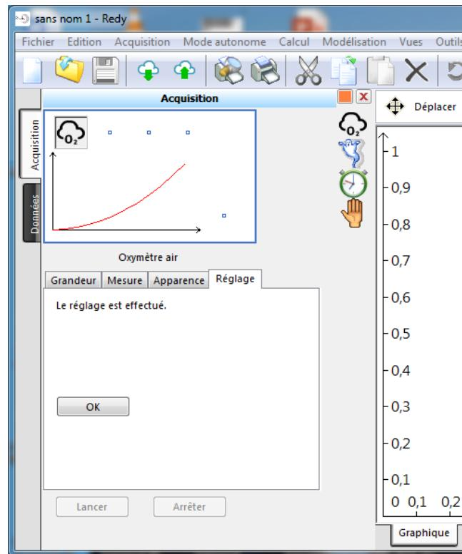
Vous pouvez vérifier dans l'onglet Mesure que la valeur mesurée est maintenant de 20.9 %, teneur de l'air en dioxygène.
