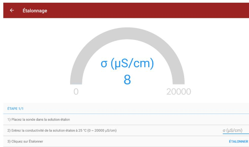
Après appui sur Étalonnage, un écran de confirmation apparaît.
