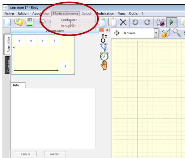
Dans la fenêtre de configuration, sélectionner le ou les capteurs que vous souhaitez paramétriser :
