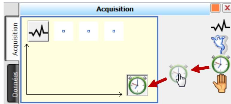
L'ensemble des indications relatives au paramétrage du temps d'acquisition apparaissent alors sous le graphique :
