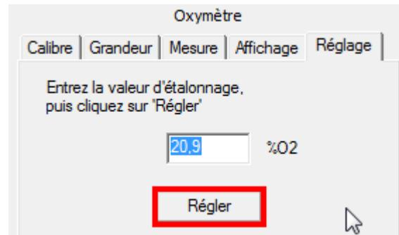
Le bouton « Régler » est entouré d'un liseré rouge, indiquant que le système est en train de vérifier les données renvoyées par la sonde.
