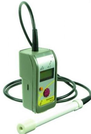
Ce capteur, à microphone intégré ou à microphone déporté, permet l'acquisition d'un signal sonore via les deux microphones et la mesure de son intensité en décibels avec le microphone intégré. Avec un microphone déporté, on ne mesure que le signal sonore en [u.a] (unité arbitraire). La fonction dB(A) dans ce cas est désactivée et le bouton du changement de fonction est inactif.
