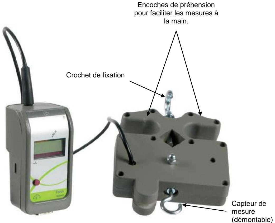
Véritable dynamomètre électronique, ce capteur permet de mesurer les forces et en particulier d'étudier poids, moment, forces concourantes, forces de traction et de compression.
