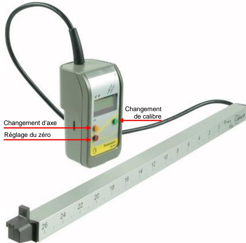
Ce capteur mesure la valeur du champ magnétique selon deux axes de 0,01 mT jusqu'à 100 mT. Il s'utilise avec les consoles Foxy, Tooxy et AirNeXT.
