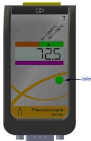
En mode autonome, vous disposez de toutes les fonctionnalités d'un multimètre. La valeur instantanée de la température est visible sur l'afficheur. Le changement de calibre s'effectue par appui bref sur le bouton calibre.
