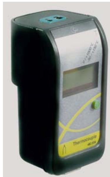
Ce capteur permet de mesurer la température associé à une sonde température thermocouple de type K.
