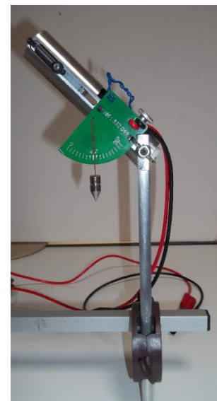
Photographie du montage du lanceur balistique
