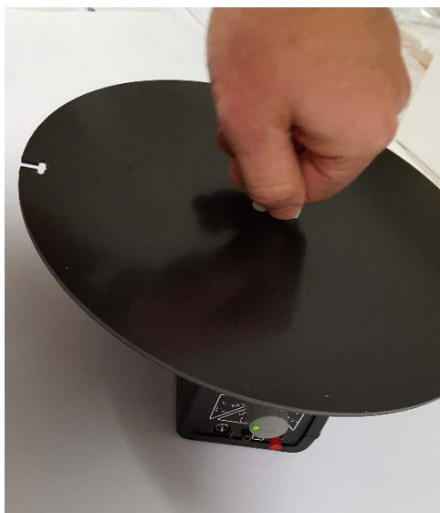
8 Serrer le disque sur le boîtier avec à l'aide des vis nylon fournies
